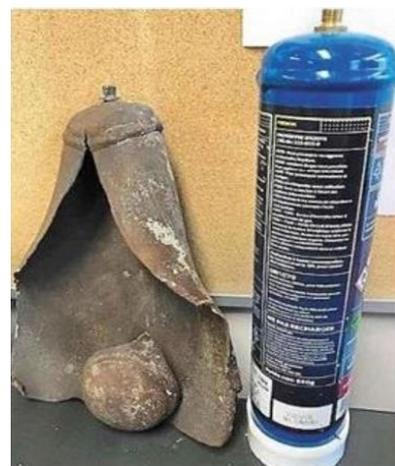
Figure 1 : Bouteille  $N_2O$  avant et après explosion
