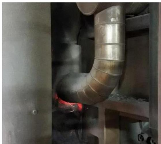
Figure 5 : Fissure latérale four
