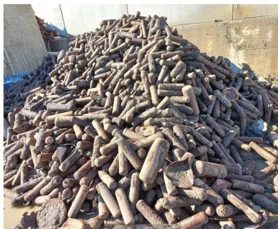
Figure 9 : Bouteilles de protoxyde d'azote récupérées sur plusieurs mois au niveau des mâchefers
