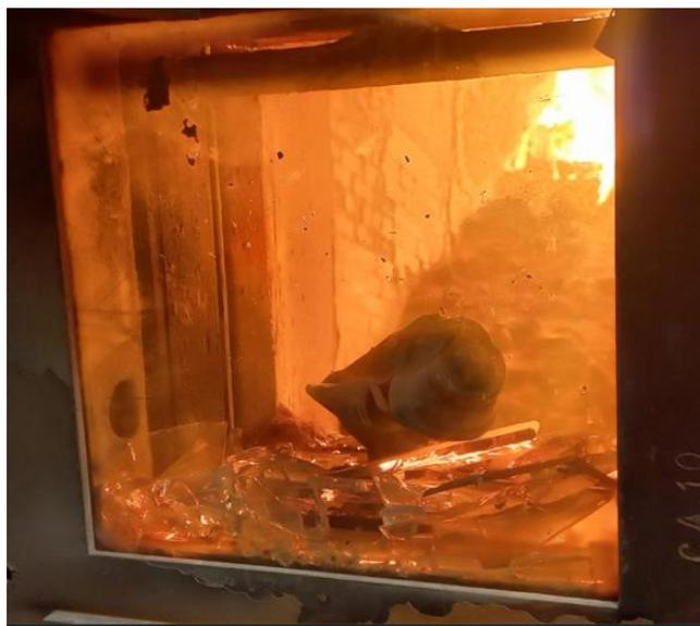
Figure 7 : Hublot du four cassé à cause d'une bouteille de protoxyde d'azote
